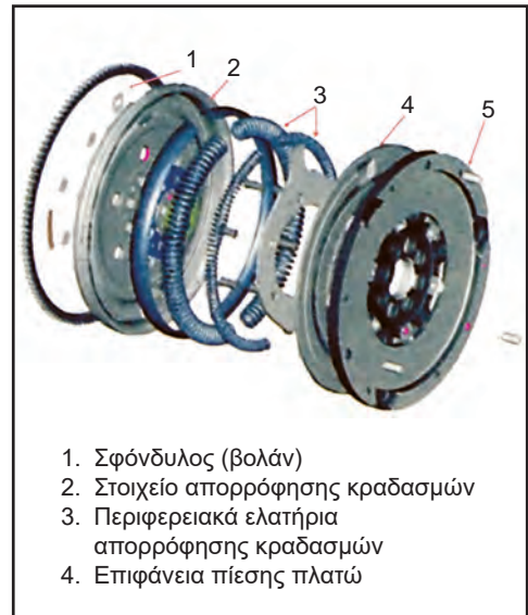
Σχήμα 1.5: Συμπλέκτης με βολάν διπλής μάζας.
