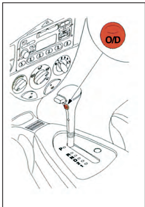
Σχήμα 1.34: Επιλογέας ταχυτήτων αυτομάτου κιβωτίου με O/D και ενδεικτική λυχνία.
