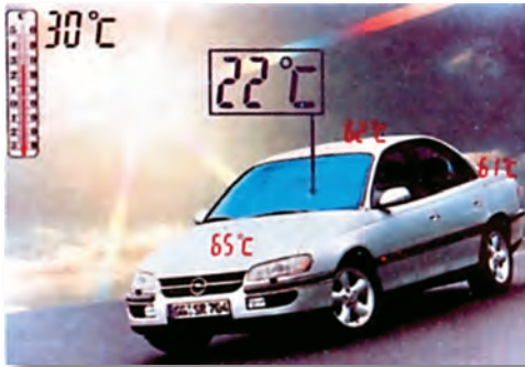
Σχήμα 6.9: Οι θερμοκρασίες γύρω από το αυτοκίνητο. Η αυξημένη θερμοκρασία στην καμπίνα των επιβατών προέρχεται από την ακτινοβολία του ήλιου όταν διαπερνά τα τζάμια ή έχει απορροφηθεί από το μεταλλικό αμάξωμα. Τα φιμέ κρύσταλλα αντανακλούν σημαντικό ποσόν ακτινοβολίας, όπως και η ανοιχτόχρωμη βαφή του αμαξώματος.
