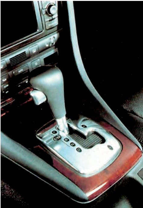
Σχήμα 1.51: Επιλογέας με θέσεις για σειριακή λειτουργία.
