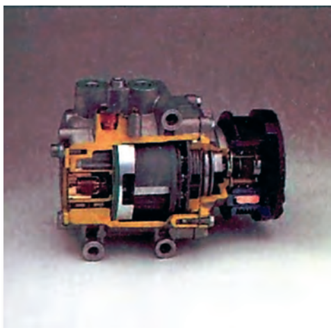
Σχήμα 6.8: Συμπιεστές και φίλτρα αφύγρανσης. Τομή συμπιεστή και μαγνητικού συμπλέκτη.
